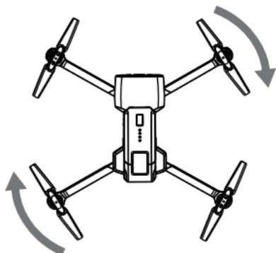
然后把飞行器放在水平位置此时飞行器尾灯长亮，然后把飞行器顺时针转 3 圈此时飞行器尾灯慢闪完成地磁校准。
